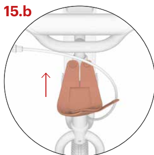
15.b Installazione delle coperture di protezione (Modello Wzoom/Tidit/Mau)
